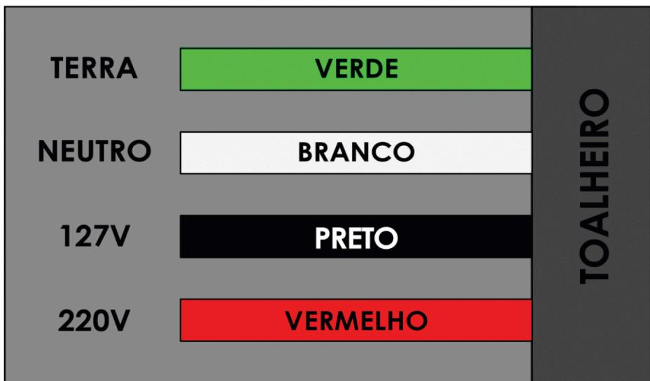
**! PARA SUA SEGURANÇA, SEMPRE CONECTE O FIO TERRA (VERDE) DO TOALHEIRO TÉRMICO. Assegure-se que o fio terra do seu ponto elétrico esteja ativo. O fio terra normalmente é de cor verde ou verde com uma faixa amarela.**
